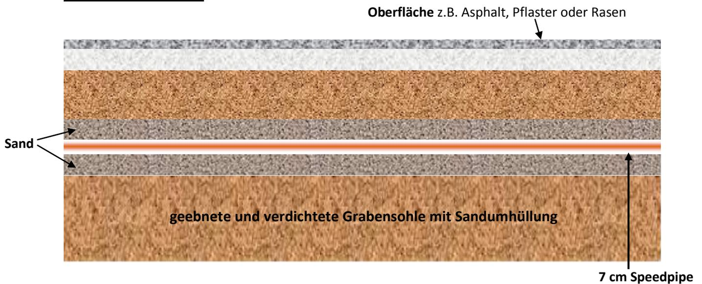
Die Grabensohle soll plan sein. Eine Welligkeit der Sohle, wie sie z.B. durch einen Bagger entstehen kann ist auszugleichen. Sand und Speedpipe werden bauseits gestellt.
